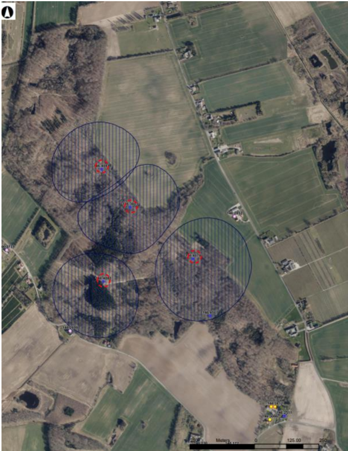
Figur 7.2. BNBO ved Bremerskov Kildeplads. Stiplet cirkel er 25 m zone. Blåkravering er BNBO
