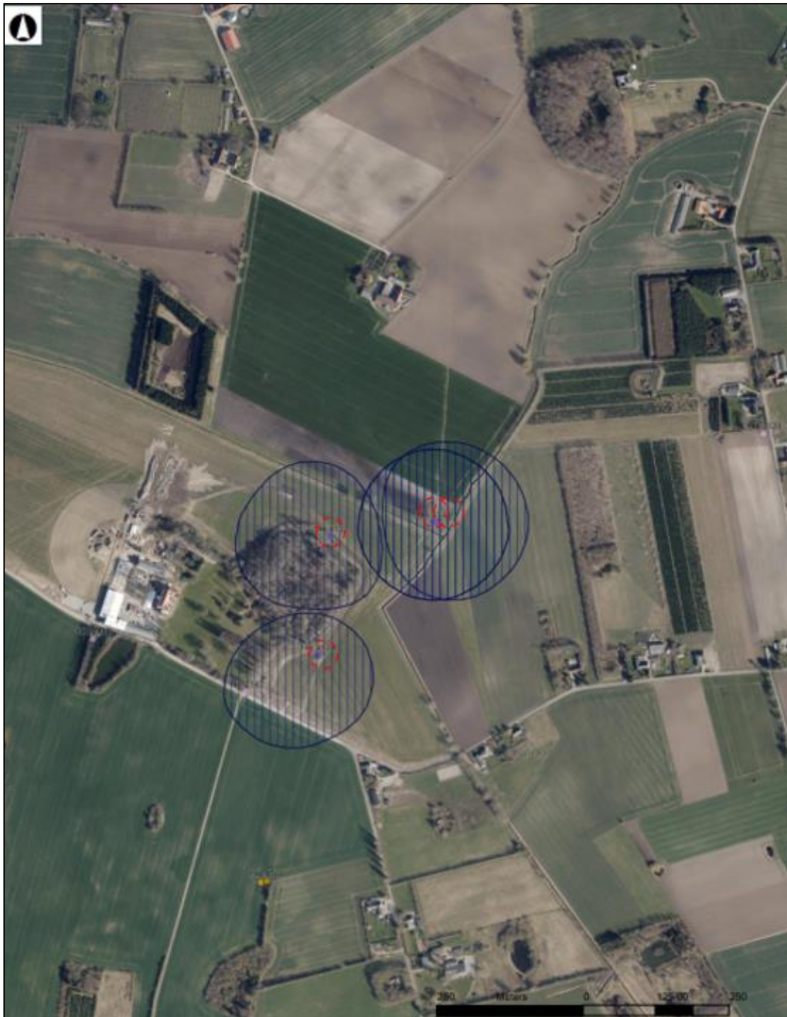
Figur 7.5. BNBO ved Skovsbo Kildeplads. Stiplet rød cirkel er 25 m zone. Blåskravering er BNBO
